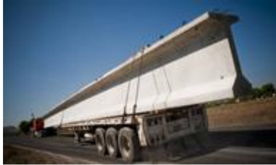
Transporte de trabe prefabricada tipo AASHTO.
