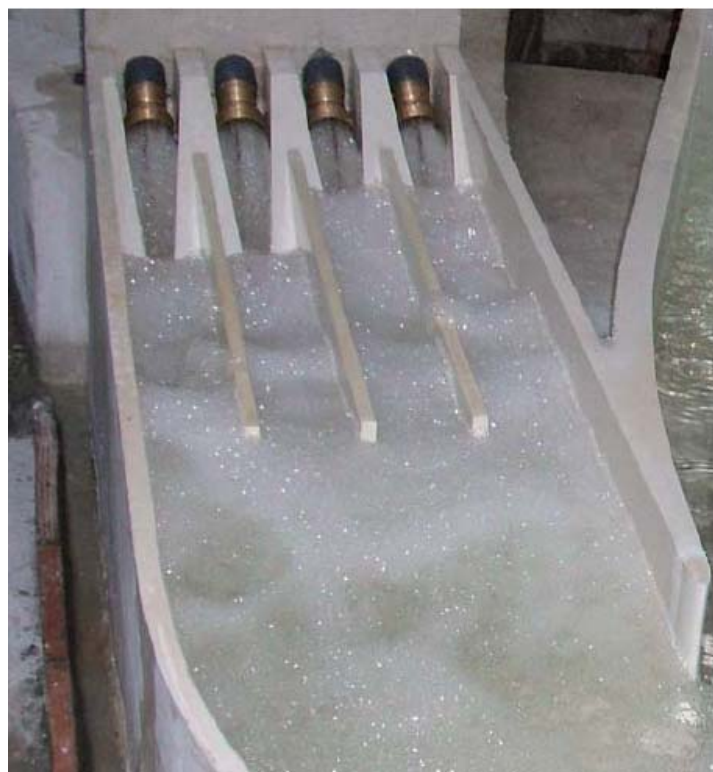
Figura VII-13 Ensayo en modelo reducido. Cuenco amortiguador de los desagües de fondo y medio fondo.
