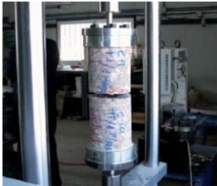
Figura VII-15 Ensayo de resistencia a tracción directa sobre un testigo con junta, efectuado en el laboratorio de obra.
