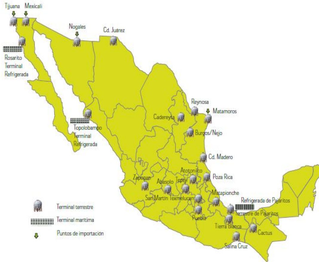
Figura 4.2: Terminales de suministro de gas LP en México, 2011.
