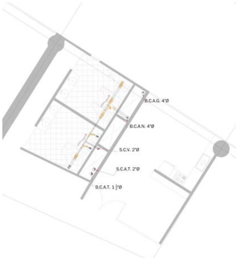
Detalle de instalación de aguas negras en baño
