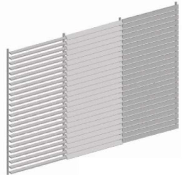
Sistema de parasoles ajustables en fachada
