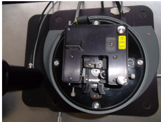
Figura 3.7.- Parte superior del equipo o lugar del porta muestra para la obtención de las imágenes de Microscopía de Fuerza Atómica (AFM).
