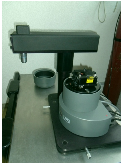
Figura 3.6.-Equipo empleado para la obtención de las imágenes de Microscopía de Fuerza Atómica (AFM).
