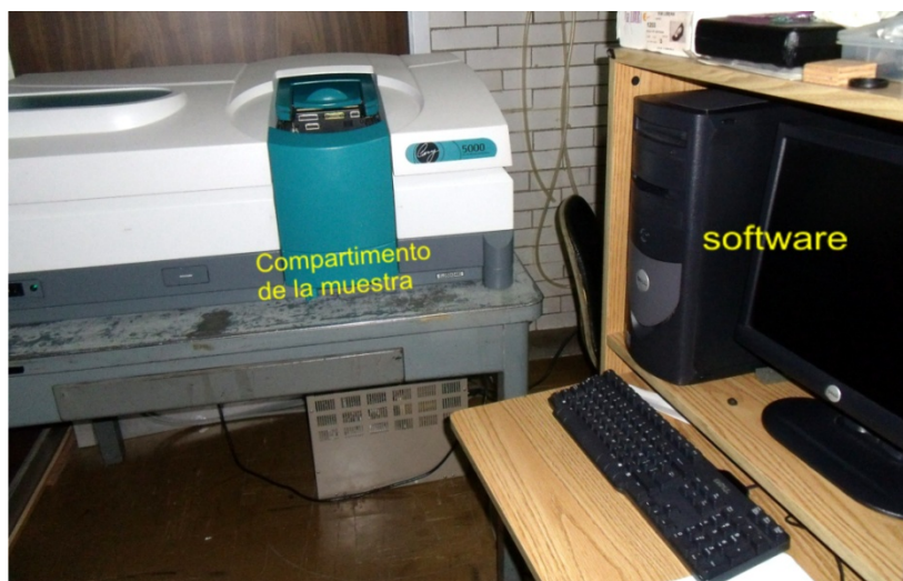
Figura 3.2.-Equipo experimental Cary 5000 (varian).
