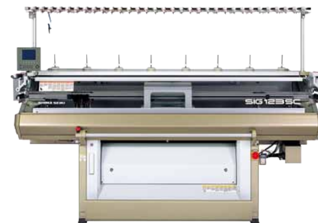
Tejedora de punto híbrida marca LAPIS Galga S10 (la galga indica el número de agujas por pulgada).
