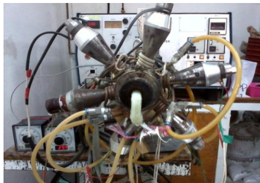
Figura 15. El extrusor marca Haake Rheocord Rheometer monohusillo tiene un cabezal con 6 piezoeléctricos que realizan una conversión de corriente alterna a ondas mecánicas, la cual proviene de un generador de onda cuadrada en el cual se pueden controlar la amplitud y la frecuencia de onda..
