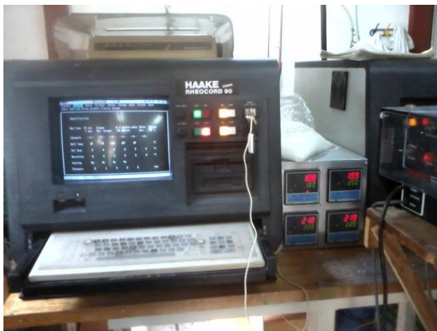
Figura 14. Extrusor TW-100 Haake Rheocord 90 con doble husillo cónico contrarrotatorio.
