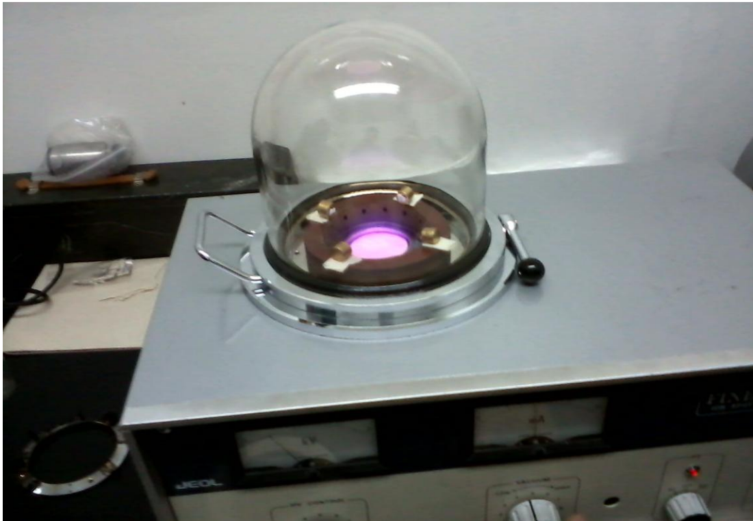
Figura 19. Evaporador al vacío JFC-1100 JEOL, las muestras de PP/CaCO 3 se están recubriendo de oro para realizar SEM.
