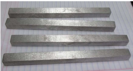
Figura 2.3 Barras de la aleación Al-20Sn (% masa) maquinadas
