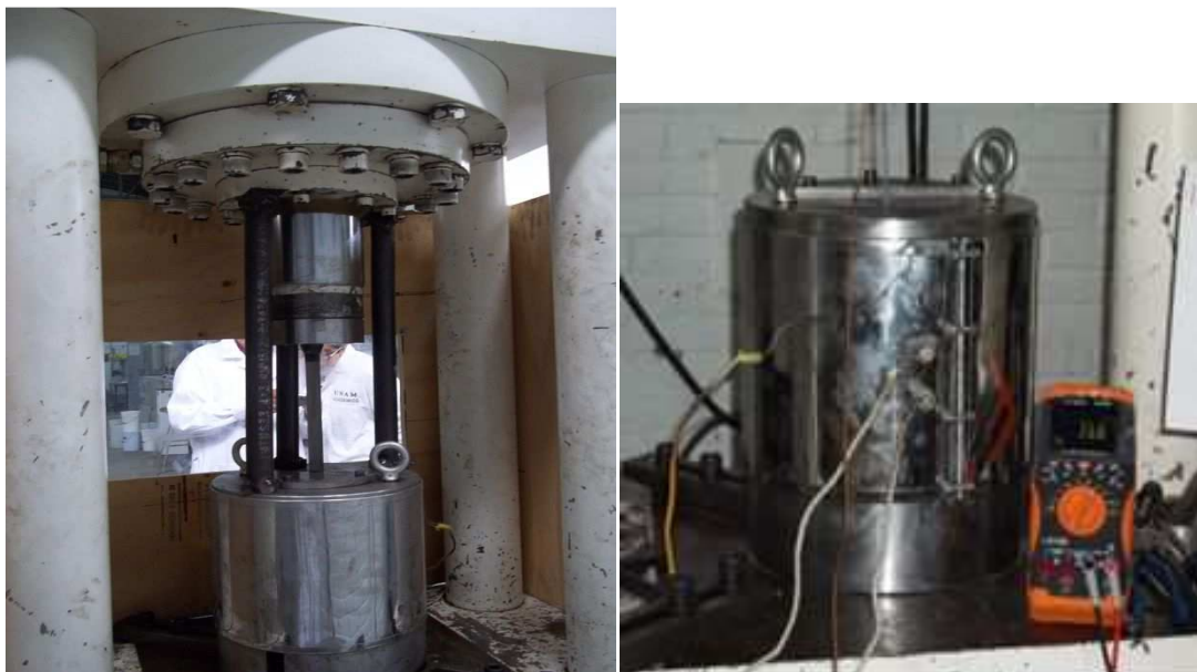
Figura A2.3 (a) Sistema con resistencia para ensayo a 105 °C (b) sistema en operación a 105 °C
