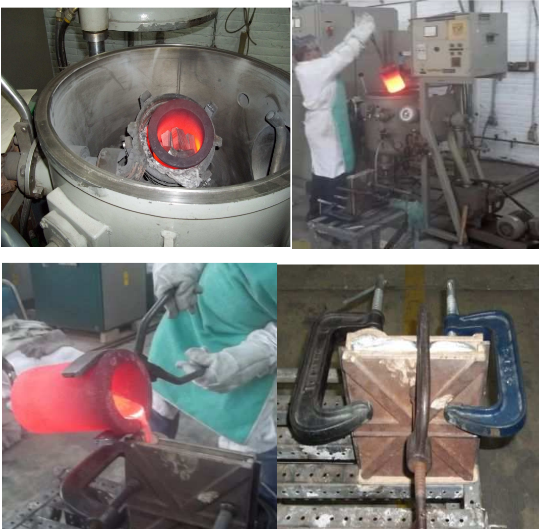
Figura 2.1 Proceso de fundición, vaciado y el molde empleado.
