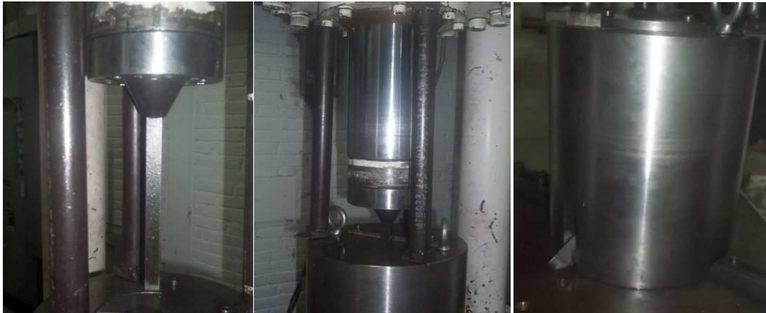
Figura A2.2 (a) Dado previo al proceso de extrusión, (b) final de proceso de extrusión y (c) salida de muestra
