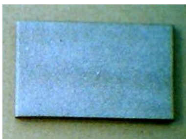
Figura 4 Recubrimiento obtenido en el proceso de rociado.
