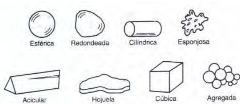
Figura 1.6 Varias formas de partículas en metalurgia de polvos. 4
