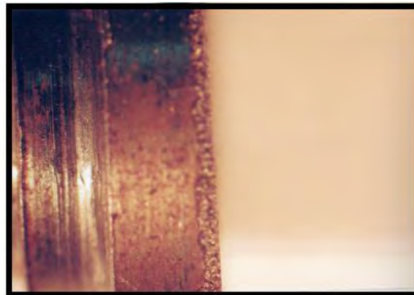
Figura 7.17 Probeta 2 c/ recubrimiento, tiempo de rociado= 1.5 min. sin carear c/ desgaste a 8X, se aprecia que después de la prueba de desgaste se conserva el recubrimiento con las marcas de desgaste aunque hay aglomeramiento en la periferia de los splats debido a la velocidad empleada en el ensayo. El recubrimiento tiene buen desempeño al desgaste (vista lateral)
