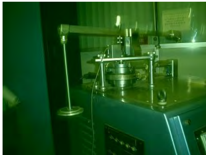
Fig. 6.3 Mecanismo de sujeción-carga de la máquina de desgaste.
