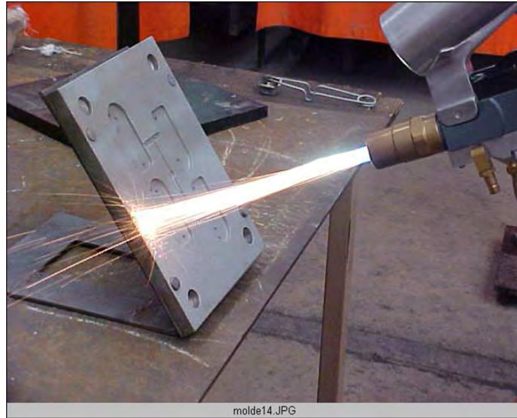
Figura 5.7 Proceso convencional de proyección térmica
