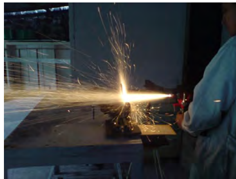
Figura 7. Proceso de proyección térmica con alimentación de alambre.
