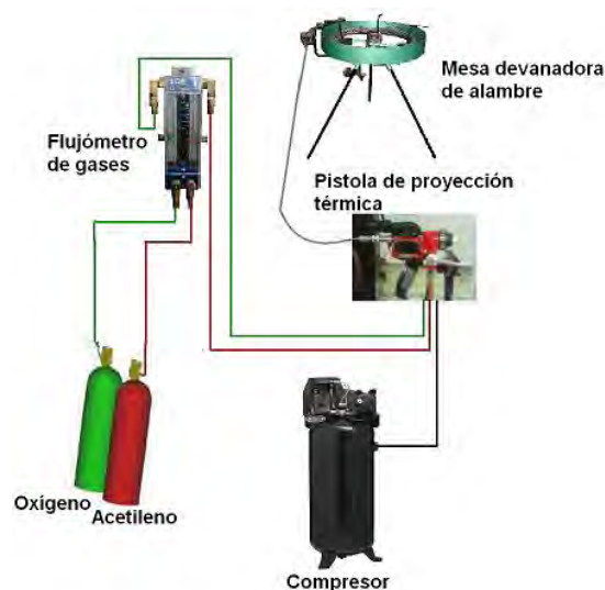
Figura 5. Equipo de proyección térmica por alambre
