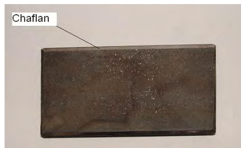
Figura 1. Probeta de acero cortada, con chaflán.
