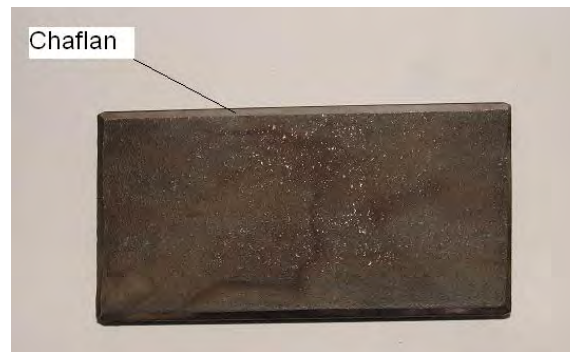
Figura 7.2 Probeta de acero cortada, con chaflán.
