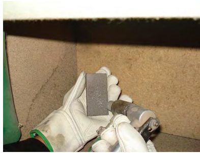
Figura 2. Proceso de granallado
