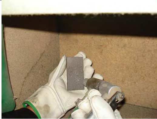
Figura 7.3 Proceso de granallado
