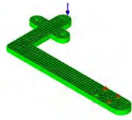
Fig.3 Mallado del soporte y aplicación de condiciones de frontera.
