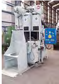
Figura 1.9 Equipo de granallado de cinta rotativa
