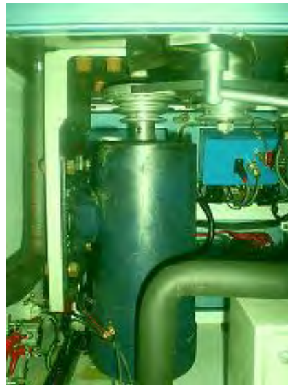
Fig. 6.7 Motor de imán permanente adaptado
