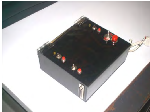
Figura 4.23. Caja de Control
