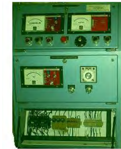
Fig. 6.2 Tablero de control de la máquina para estudios de tribología Cignus II
