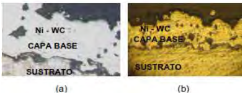
Figura 2.3 . Aspecto superficial del recubrimiento de Ni - WC usando (5) . (a) Menor energía (b) Mayor energía
