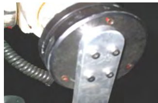
Fig. 8. Soporte de la Pistola Rociadora al brazo mecánico
