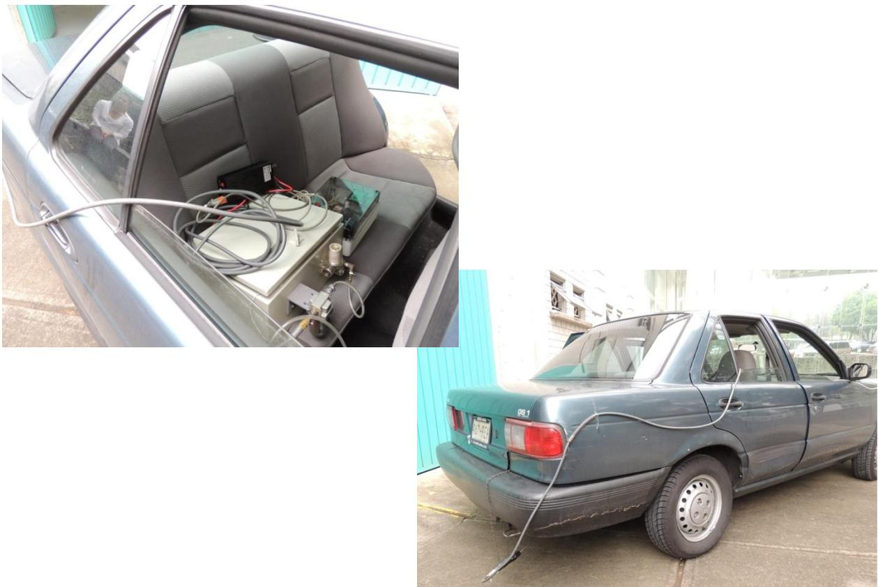
**Figura 4.22. Instalación del equipo en un vehículo ligero.**
