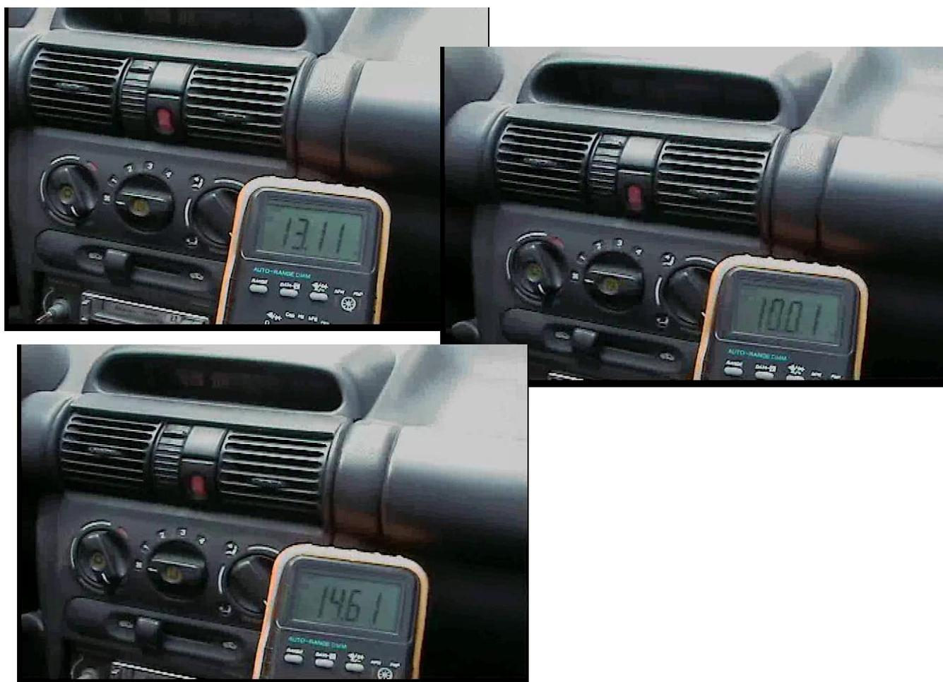
**Figura 4.13. Mediciones del voltaje de la batería.**
