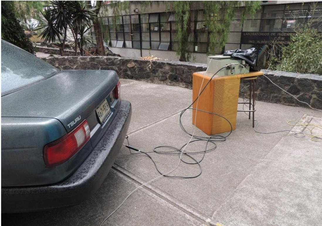
**Figura 4.12. Prueba estática al analizador de gases.**
