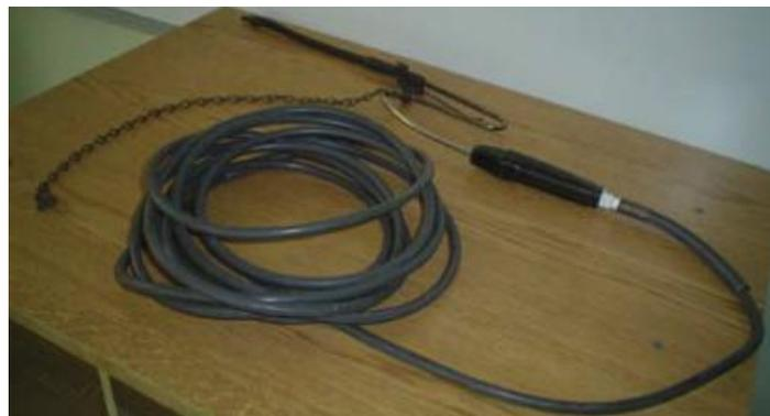
**Figura 3.19. Sonda de muestreo.**
