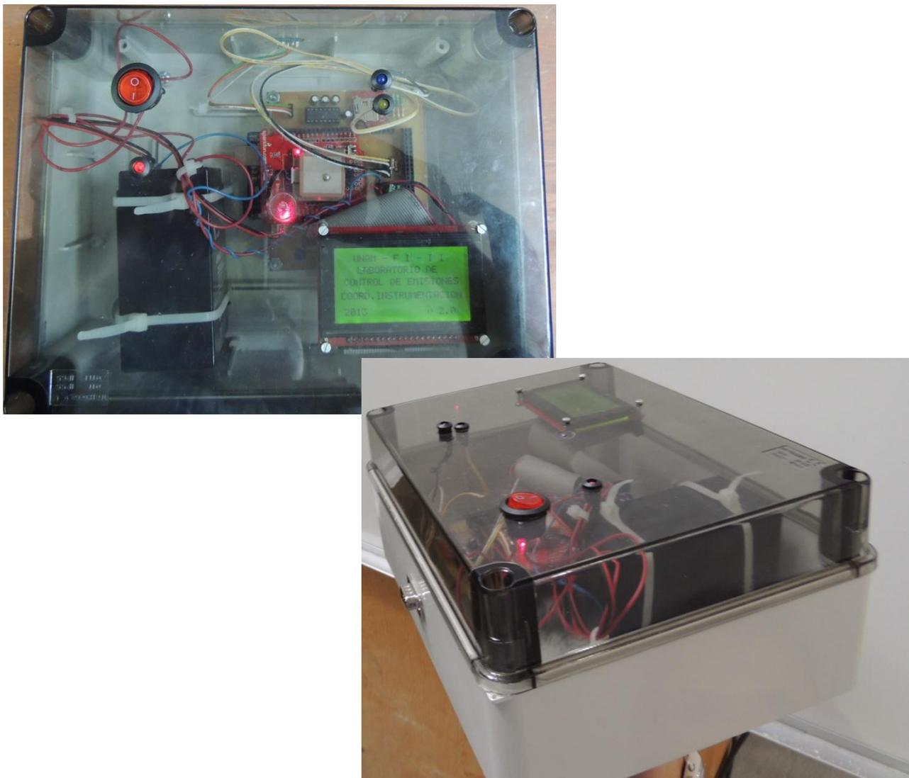
Figura 4.21. Equipo CYCLE-DAQ dentro del gabinete.
