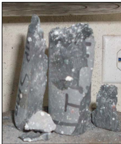
A) Núcleo de roca sometido a una prueba de compresión normal.
