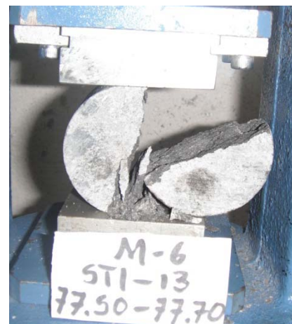
B) Núcleo de roca sometido a una prueba de tensión.
