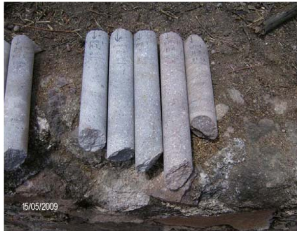
Figura 6. Muestras de roca intacta para la realización de pruebas en laboratorio.
