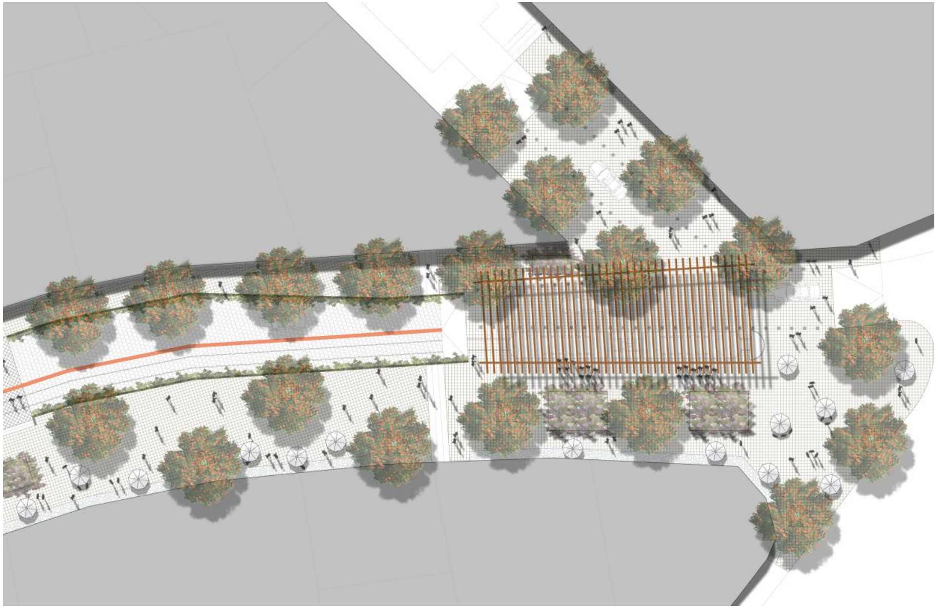
En la intersección del Paseo de los Tabachines con la Av. Morelos en el extremo sur, la sección vial se reduce con la ampliación de la banqueta y la generación de un espacio público vinculante que sirve de acceso al Paseo y la primera estación de tranvía.
