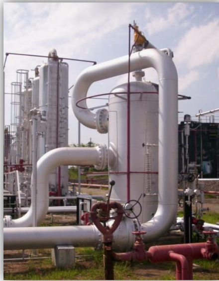
Figura 2.5 Separador de flujos
