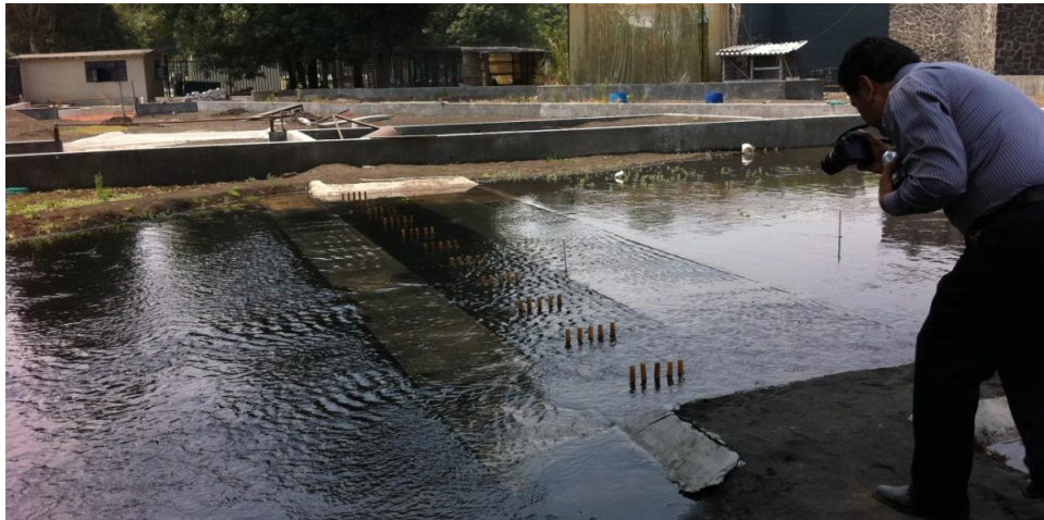
Figura 4.4.- Modelo físico de la estructura de comunicación Zapotes – Don Julián. FUENTE: CONAGUA 2011.
