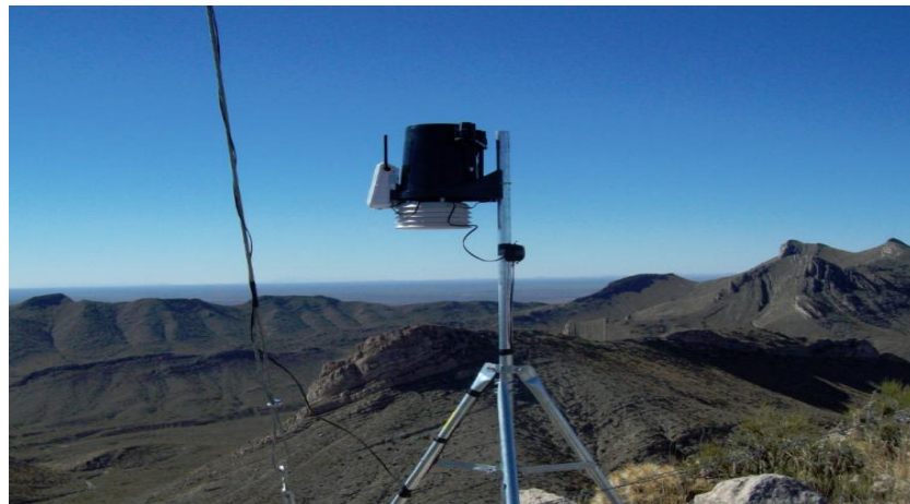
Figura 2.19.- Pluviógrafo integrante de una EMA ubicada en la sierra de Ciudad Juárez, Chihuahua.
