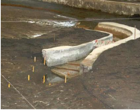
Figura 4.2.- Estructura de control de margen derecha sobre el río Carrizal (Fotografía izquierda: Modelo Físico, Fotografía derecha: Prototipo) (PHIT, 2010).
