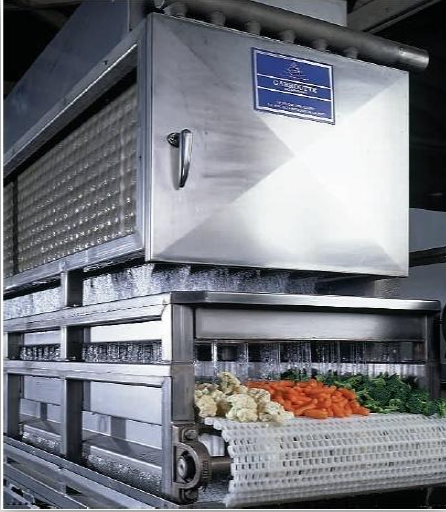
Figura 20. Preenfriador por aspersión (Meyer Industries, 2010).
