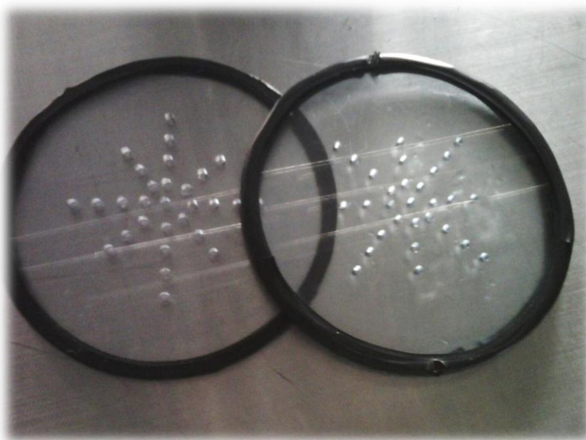
Figura 26. Placas para generar chorros fluidizantes.
