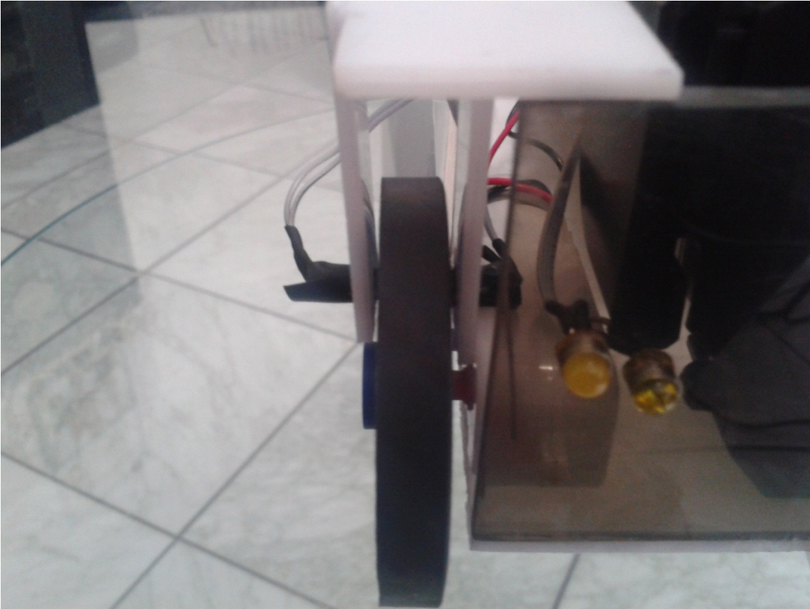
Fig 7-11 salpicadera diseñada para soportar sensor y LED
