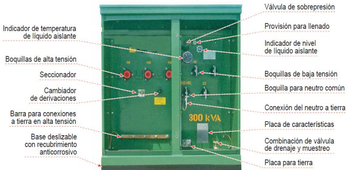
Figura 7.5 Transformador tipo pedestal de frente muerto.
