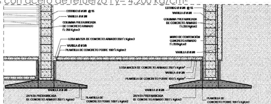
Detalle de la cimentación de candelero con Zapata
