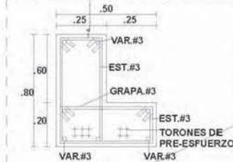
**DETALLE D-3: ARMADO DE COLUMNA PREFABRICADA**
