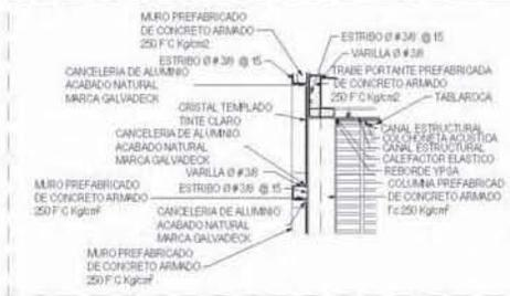
**DETALLE D-6: ARMADO DE MARCO DE CONCRETO Y LOSA TT PREFABRICADA**
