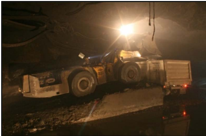
Imagen 20: Scooptram cargando de mineral un camión de acarreo
