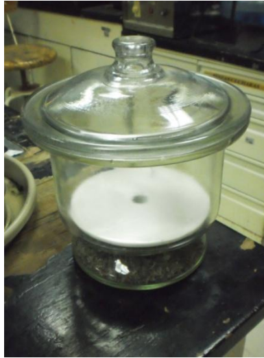
Figura 4.6. Desecador usado para enfriar las muestras evitando la hidratación de la muestra.
