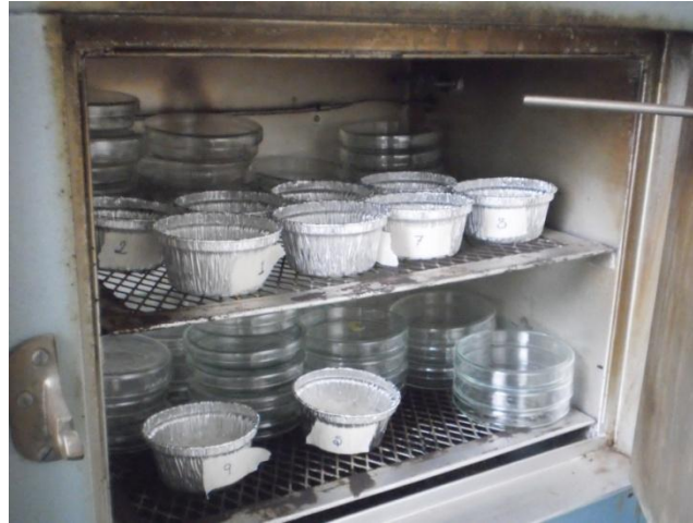
Figura 4.4. Muestras en recipientes de aluminio dentro de la estufa marca Riosa.
