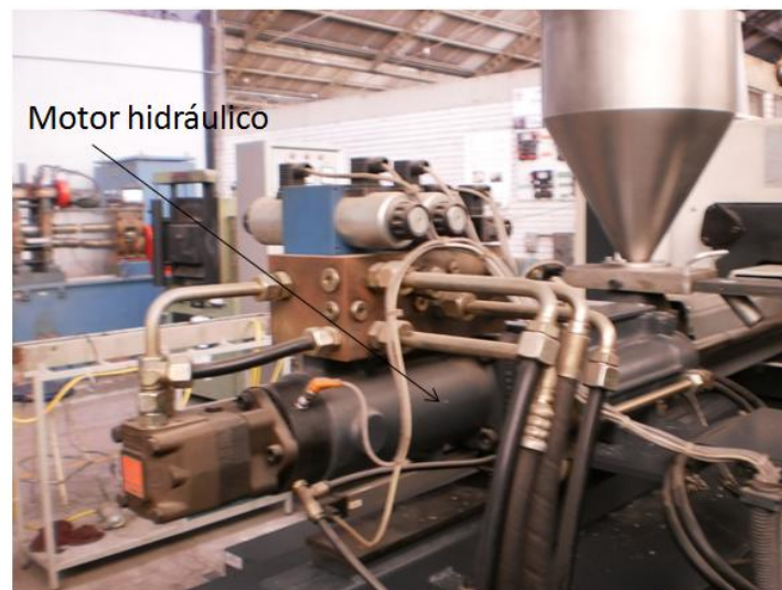
Figura 2.8 Ubicación del motor hidráulico en la máquina de inyección.
