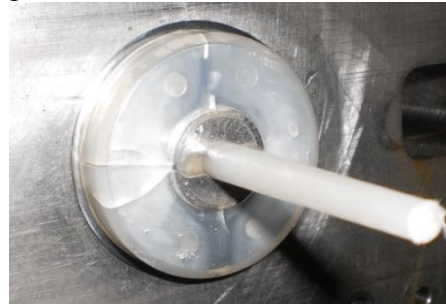
Figura 4.70 Líneas de flujo y fractura en la pieza actuador.
