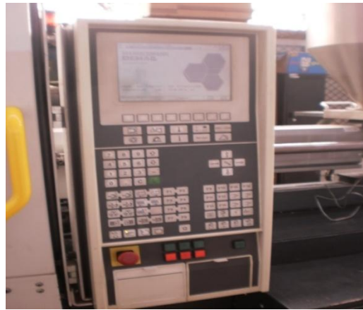
Figura 2.10. Unidad de control, manejo de variables por ejemplo control de material a inyectar
