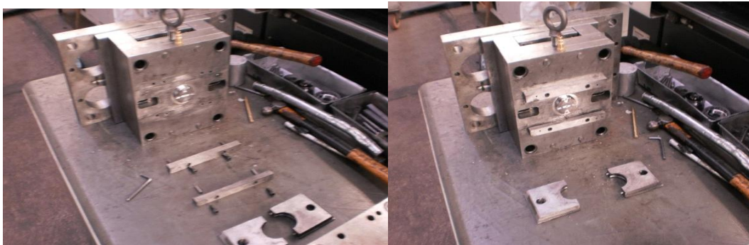
Figura 3.39 Ensamble de piezas que conforman la placa de pieza base. Detalle del ensamble de las correderas y la sujeción con tornillos.
