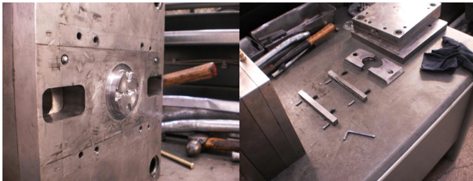
Figura 3.39 Ensamble de piezas que conforman la placa de pieza base. Detalle del ensamble de las correderas y la sujeción con tornillos.
