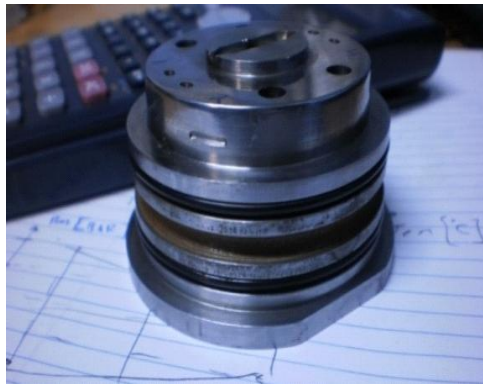
Figura 3.50 Inserto para la fabricación del actuador donde se observan los empaques y el canal de refrigeración.
