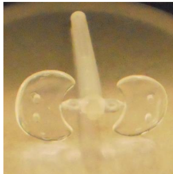
Figura 4.31 moldeo de canales primarios
