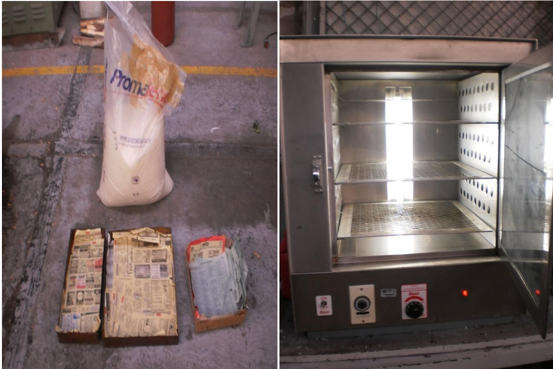
Figura 4.2. Estufa de Cultivo del Laboratorio de Procesamiento de Plásticos, izquierda y derecha charolas de uso para el secado del material.
