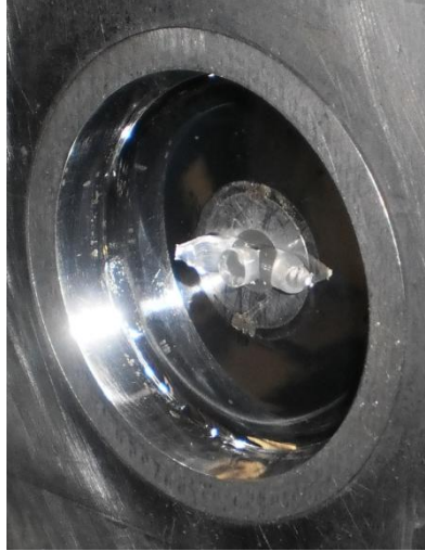
Figura 4.69 Vela de la pieza dosificador retenida en bebedero del molde.
