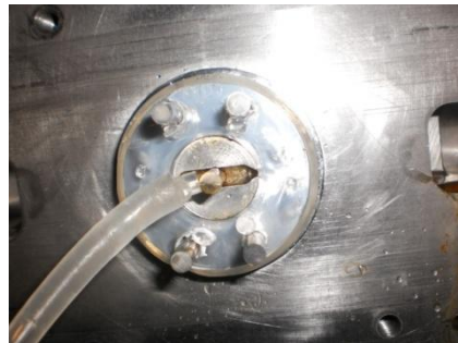
Figura 4.74. Deformación de la pieza debida al empuje de los pernos expulsores en combinación con la flexibilidad excesiva del material por falta de tiempo de refrigeración.
