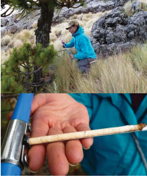
Figura 3.10. Obtención de núcleos o virutas de un individuo de Pinus hartwegii . Muestra IzTim-56 con 38 anillos contados y una edad aproximada de 42 años. Foto tomada a ~4,240 msnm el 15 de noviembre de 2012.
