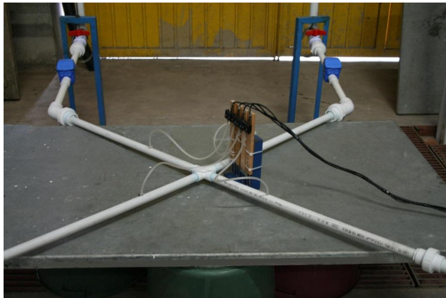
Figura 5.8 Sensores de presión conectados a la tubería
