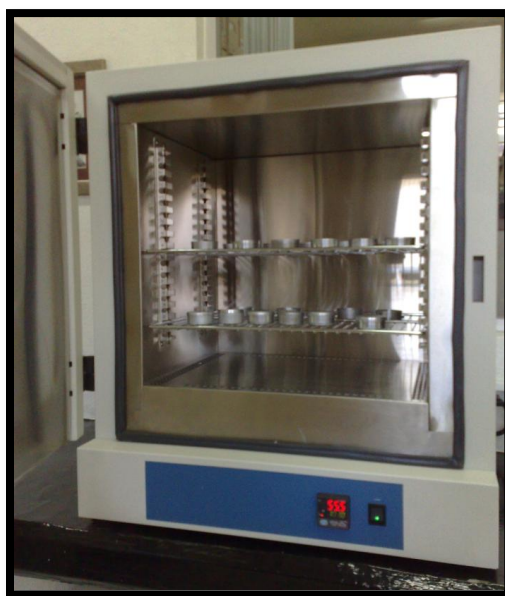
Figura 2.8 Estufa para determinar humedad Lindberg Blue Modelo: TS7182W87
