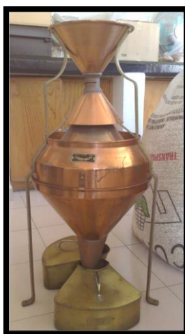
Figura 2.3 Homogenizador de granos Seedburo Quality
