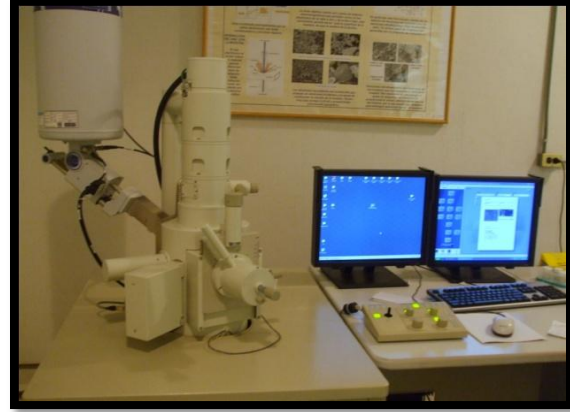
Figura 2.16 a) Preparación de las muestras b) Microscopio Electrónico de Barrido
