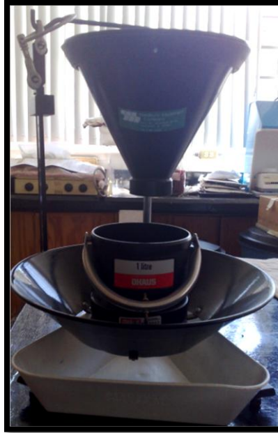
Figura 2.5 Balanza específica marca OHAUS para determinar peso hectolítrico
