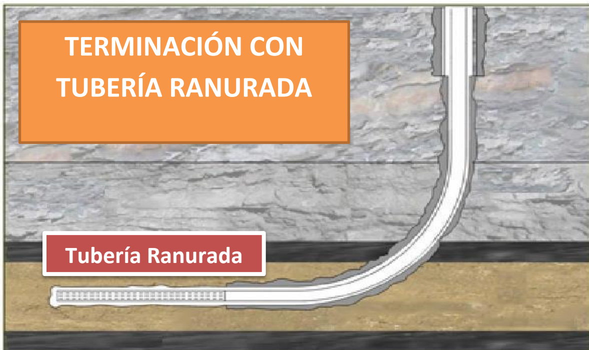
○ Figura 3.4 Diagrama de un pozo horizontal terminado con tubería ranurada.
