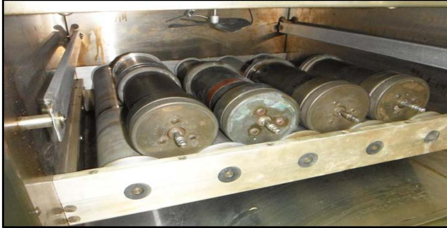
Figura 5.12 Equipo de rodado, con celdas de acero selladas herméticamente
