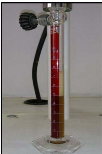
Figura 6.3 Volumen de filtrado de la prueba APAT.
