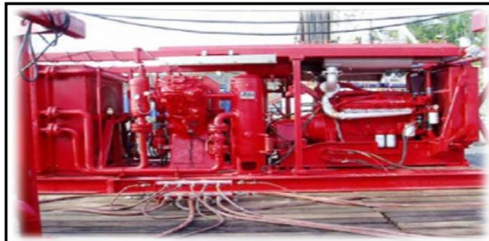
**Figura 2.20 Booster Empleado en Operaciones de Perforación con Espuma.**
