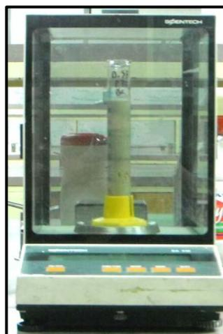
Figura 5.14 Balanza de precisión y probeta graduada
