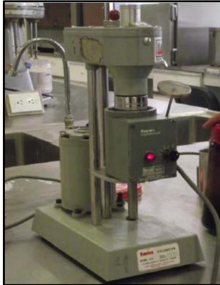
Figura 5.17 Viscosímetro rotacional Fann 35-A
