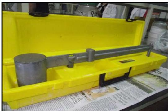
Figura 5.13 Balanza de lodos
