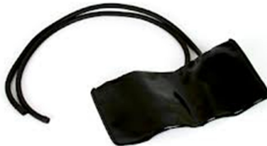
Figura 3.8. Cámara de baumanómetro de dos conductos empleada en el sistema.
