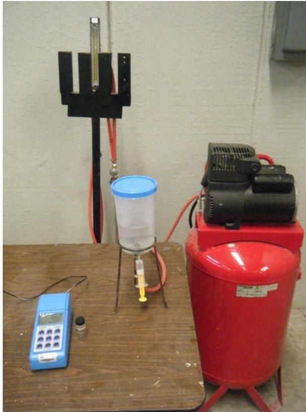
Figura 13. Modelo físico (1/32). Equipo experimental; Turbidímetro, Jeringa, Compresor, Rotámetro.
