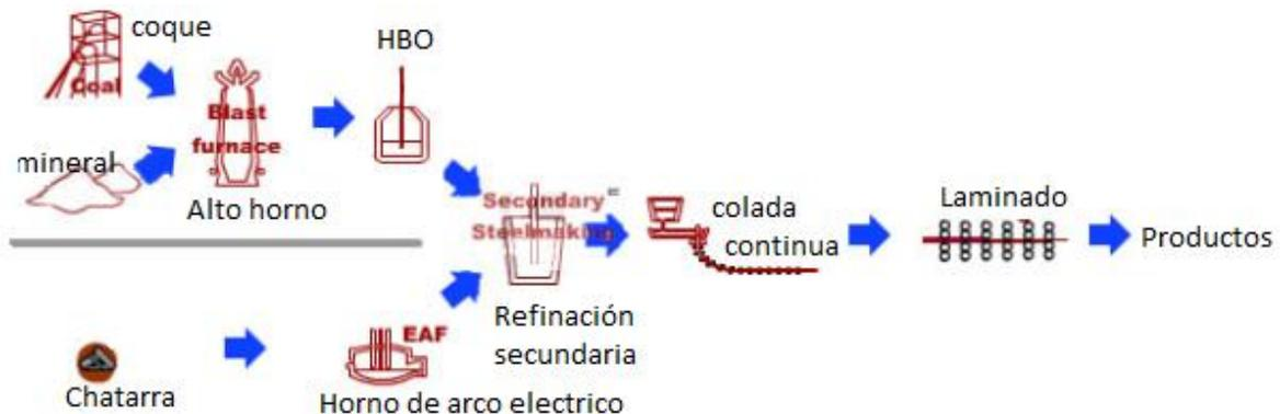
Figura 3. Etapas en la fabricación de acero<sup>18</sup>
