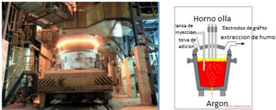
Figura 4. Izquierda. Horno olla en las instalaciones de NKMZ en Ucrania.<sup>23</sup>
