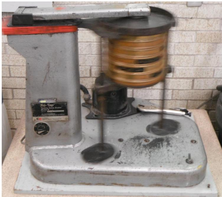
Figura 14. Ro tap donde se realizaron las pruebas de cribado del poliuretano.
