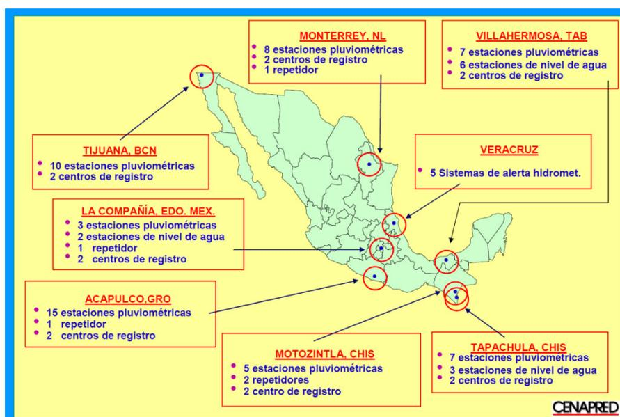
Figura 1.5 Sistemas de alerta hidrometeorológica instalados por el CENAPRED
