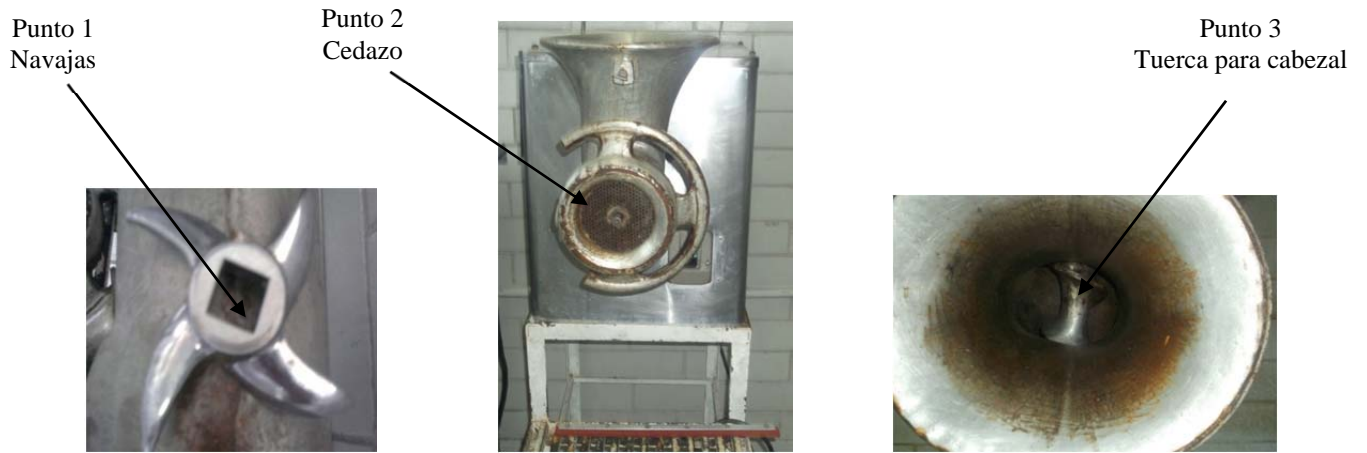
Figura 5. Identificación de puntos de riesgo en el molino
