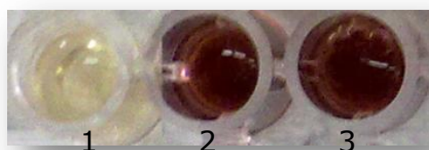
Figura 11. Medición de actividad cualitativa del extracto crudo. (1) Blanco: 75 \mu L de buffer fosfatos 50 mM pH 7.2, (2) y (3): 75 \mu L Extracto crudo del medio optimizado para la cutinasa ANCUT1. En todos los casos se adicionaron 75 \mu L de \alpha -naftil acetato y 75 \mu L de Fast Red.
