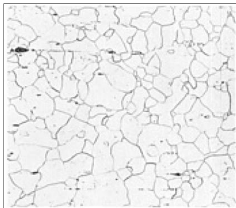
Figura 2.3. Microestructura de la ferrita vista en microscopio metalográfico a 100X y aumentada 2X [5].
