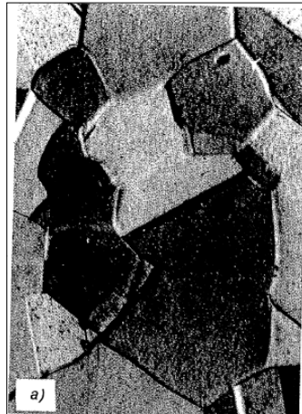
Figura 2.2. Microestructura de la austenita vista en microscopio metalográfico a 500X, tamaño de la imagen ampliado 25% [2].
