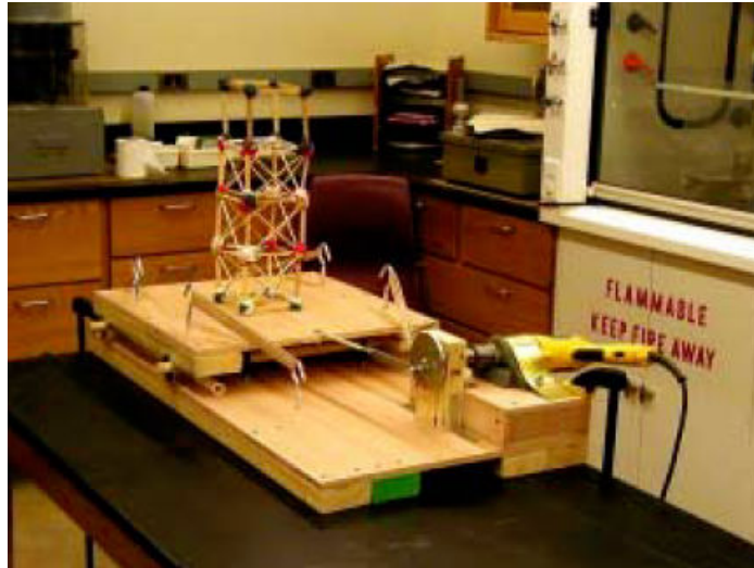
Figura B.1. Mesa vibratoria controlada por un taladro (Walch et al, 2001)
