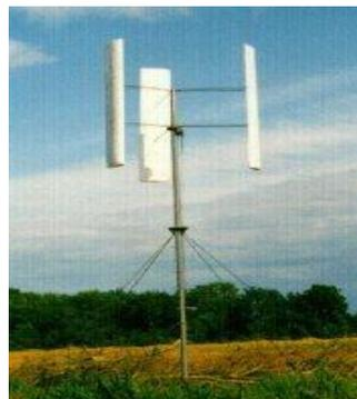
**FIGURA 1.17 Aerogenerador de eje vertical tipo Giromill [36].**
