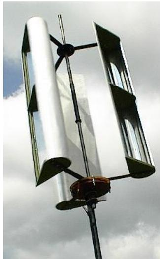
**FIGURA 1.20 Aerogenerador de eje vertical tipo Lenz [38].**
