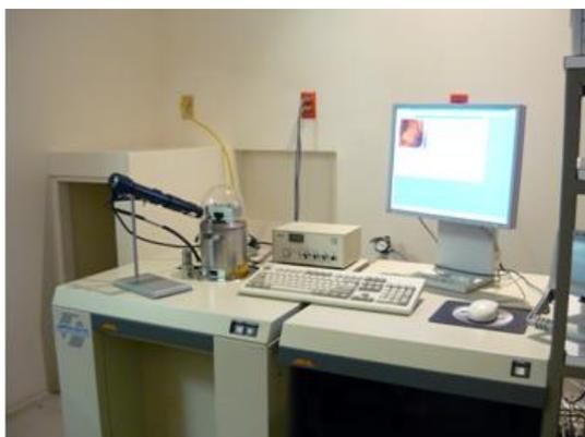
Fig. 5.4.3 Microscopio de Fuerza Atómica JEOL JSPM 4210.
