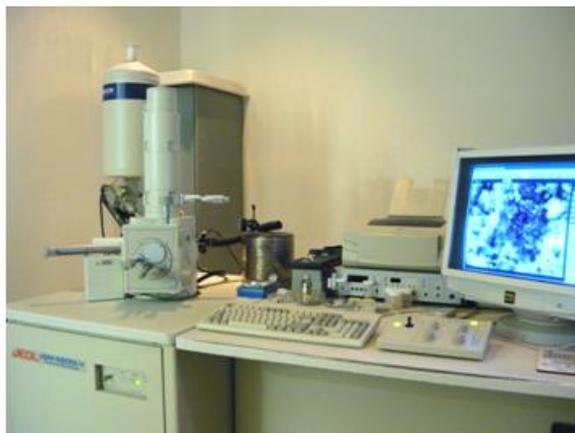
Fig. 5.4.2. Microscopio electrónico de barrido JEOL SEM 5600LV.
