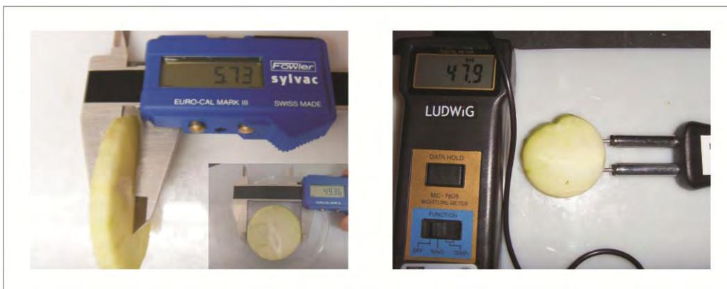
**Figura 4.** Medición de área y %HR.
