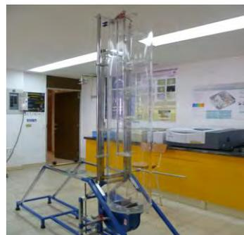
**Figura 2** Secador prototipo en posición vertical.
