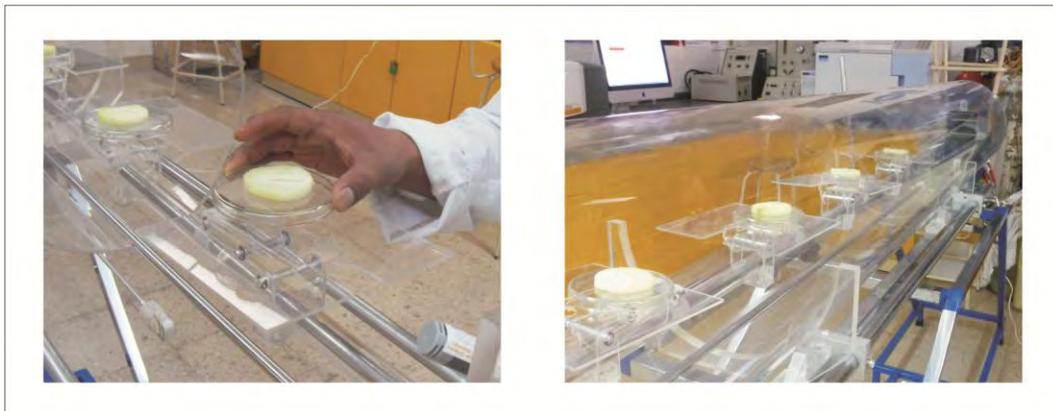
**Figura 6.** Distribución de las muestras en el secador.
