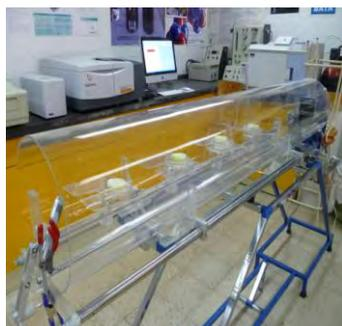
**Figura 1** Secador prototipo en posición horizontal.
