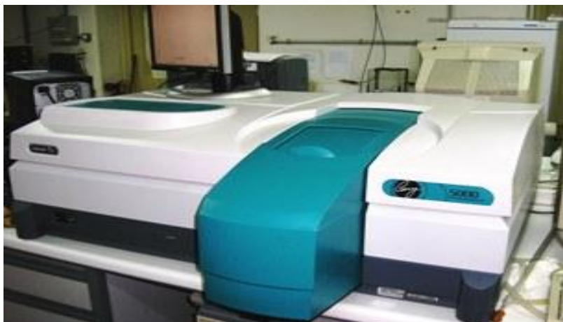
Figura 3.3 Aspecto exterior del espectrofotómetro Cary – 5000
