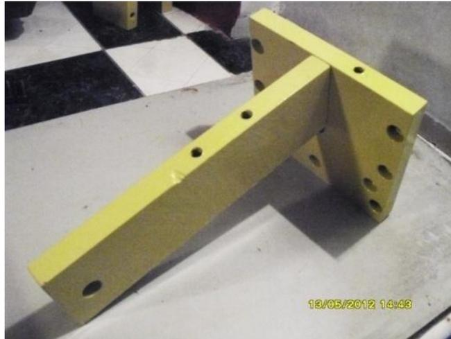
*Fig. 4.5.1 Ensamble de la placa transversal y soporte de actuador.*
