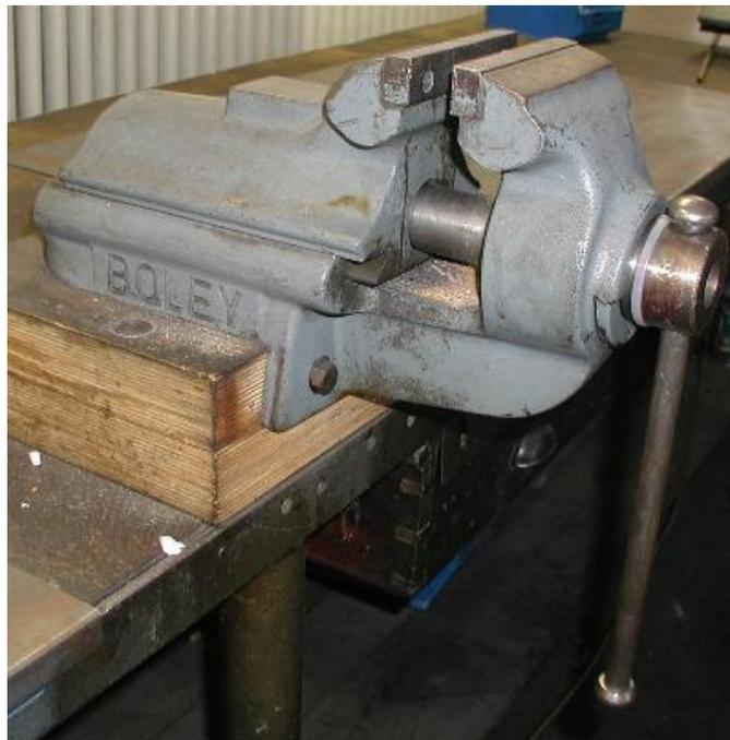
*Fig. 1.1.2 Tornillo de banco instalado sobre una mesa de trabajo.*
