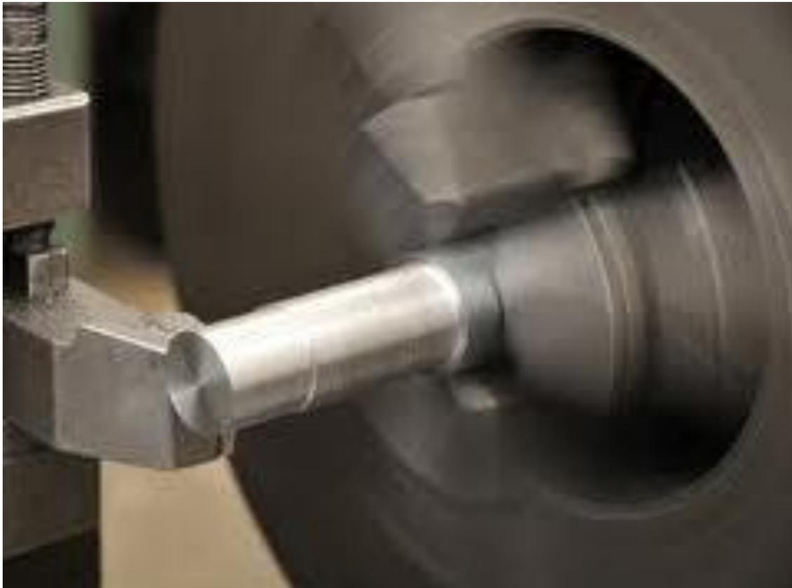
*Fig. 2.2.5.1 Aunque en el torno es posible maquinar una gran variedad de perfiles solidos de distintos materiales, la unica superficie obtenida es la cilindrica.*
