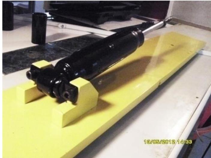
*Fig. 4.3.1 El amortiguador posee una articulación en su punto de anclaje.*
