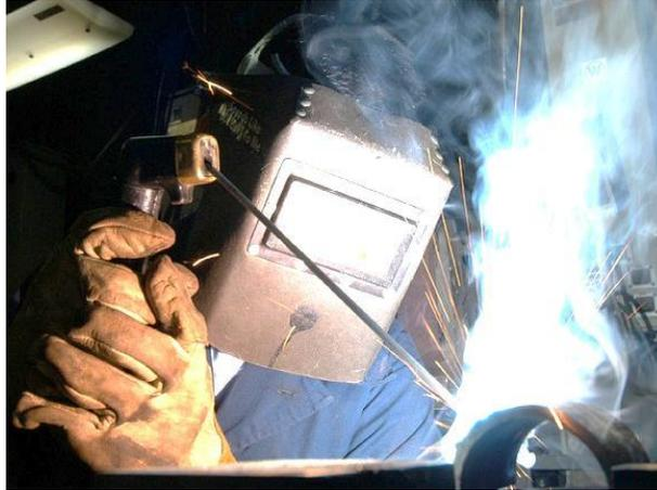
*Fig. 2.2.3.1 La soldadura por arco eléctrico es todavía el método más práctico en la industria de la manufactura. Requiere de equipo de muy bajo costo y debido a la simplicidad de sus componentes el mantenimiento requerido es muy escaso.*
