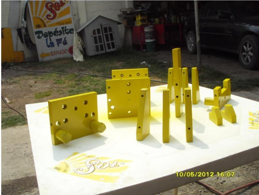
*Fig.2.6.2.2 Las piezas fueron pintadas a la intemperie para evitar concentraciones de solventes vaporizados.*
