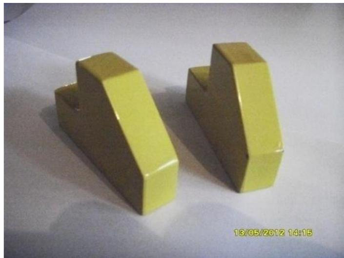
*Fig. 4.2.2 Los dados son el punto de anclaje del cuerpo del amortiguador.*
