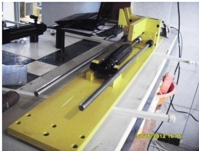
*Fig. 4.6.2 Las guías son las encargadas de mantener alienados los cabezales móviles durante su recorrido.*
