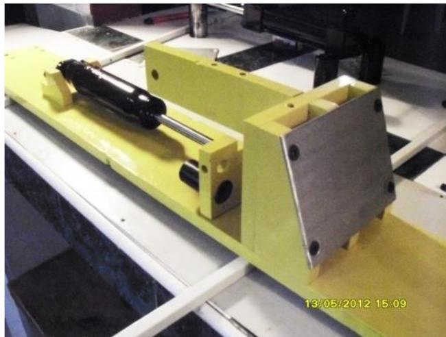
*Fig. 4.5.2 La placa de datos es una lámina de aluminio que integrará una etiqueta con adhesivo para ilustrar las características operacionales del mecanismo.*
