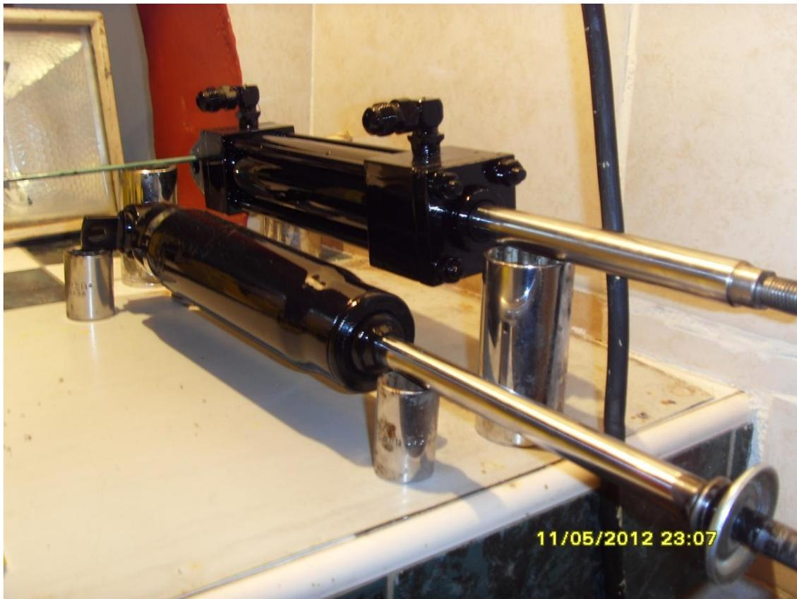
*Fig. 1.3.3 Amortiguador y actuador de dimensiones proporcionales.*
