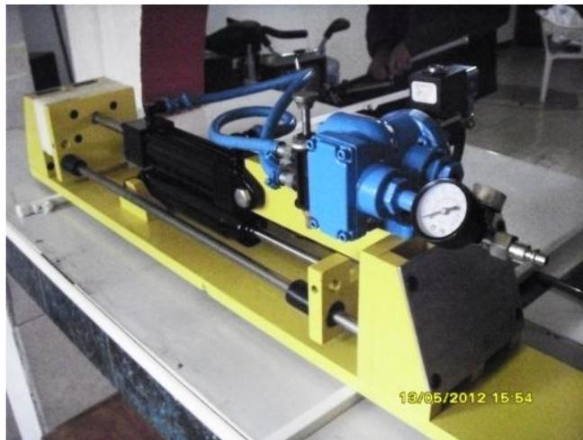
*Fig. 4.10.2 La construcción mecánica del mecanismo finaliza con la instalación del conjunto de válvulas.*
