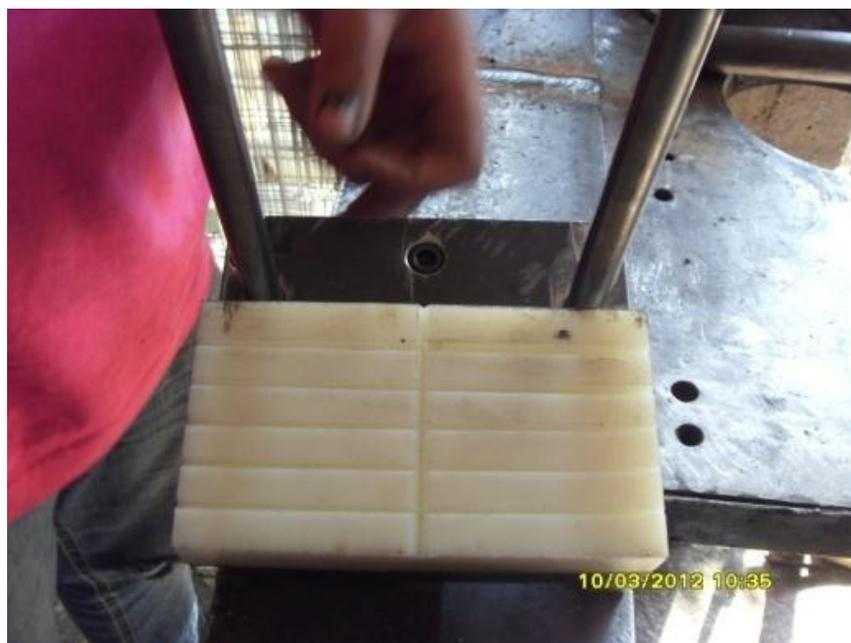
*Fig. 2.2.2.2 Aunque el Nylamid es fácil de cortar mediante el aserrado, la superficie texturizada fue maquinada a través de un cortador instalada en la fresadora.*
