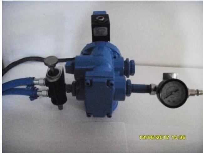
*Fig. 4.10.1 Construcción del conjunto de válvulas a través del cuerpo robusto de la válvula solenoide.*
