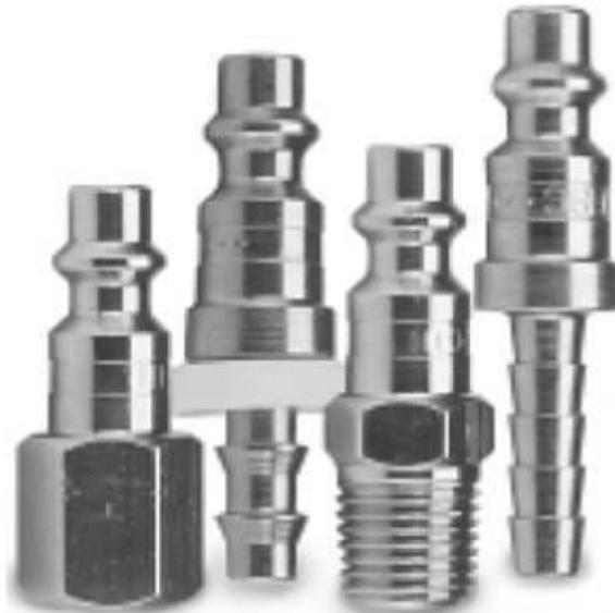
*Fig. 3.5.1 Las coples y niples neumáticas permiten conectar los distintos conductos para que el aire circule desde el recipiente del compresor hacia las distintas válvulas y finalmente al actuador.*
