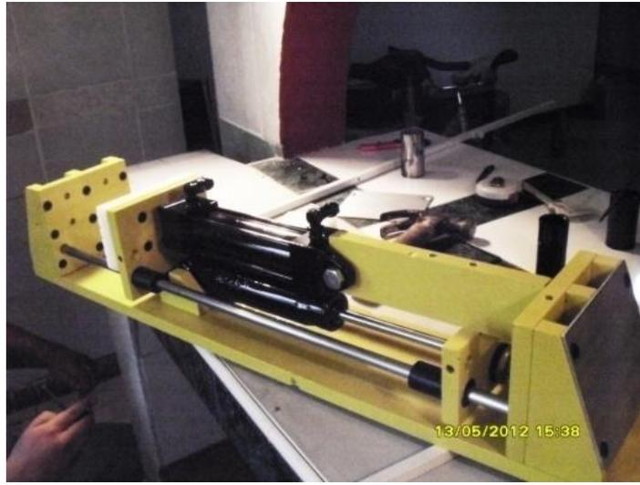
*Fig. 4.9.1 A partir de la instalación del actuador, es posible apreciar el arreglo mecánico en paralelo descrito en el primer capítulo.*
