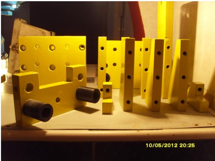
*Fig. 2.6.2.3. El secado de la pintura se llevo a cabo en una zona aislada para evitar la adherencia de impurezas en la superficie de las piezas.*
