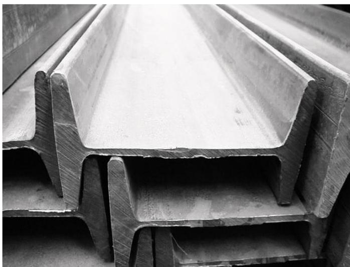
*Fig. 2.1.1.1 El acero A36, tiene una densidad de  $7860 \text{ kg/m}^3$  ( $0.28 \text{ lb/in}^3$ ). En barras, planchas y perfiles estructurales con espesores menores de 8 plg (203,2 mm) tiene un límite de fluencia mínimo de 250 MPa (36 ksi), y un límite de rotura mínimo de 410 MPa (58 ksi).*
