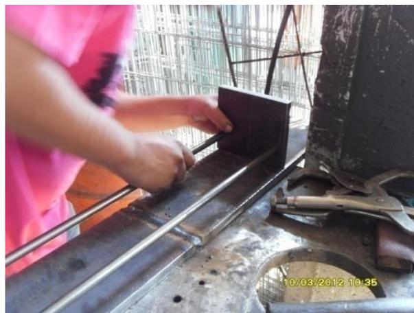
*Fig. 2.2.3.2 El proceso de soldadura se llevo a cabo para unir las dos placas que constituirían la placa base del mecanismo. Se utilizo soldadura 70/18 para acero estructural. La unión consta de 5 cordones de soldadura de 6" de longitud por 1" de ancho con un espesor de 1/8" por cordón.*
