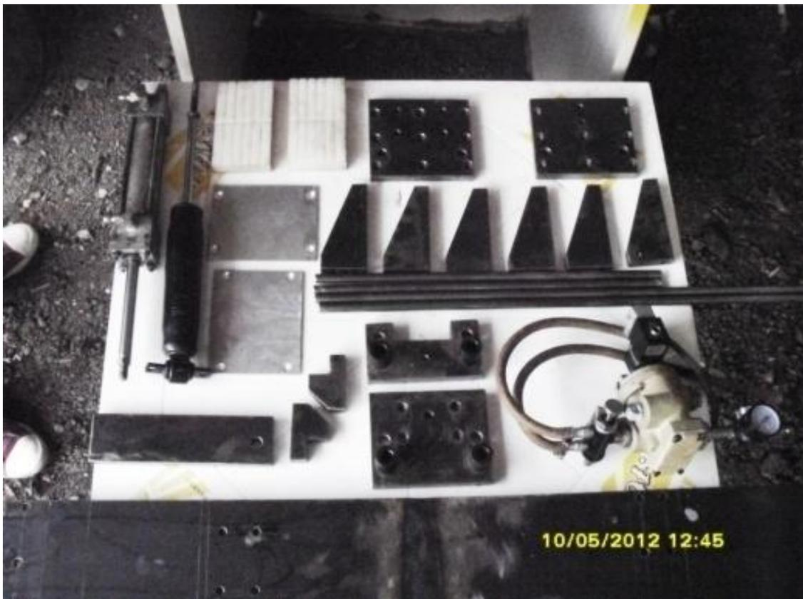
*Fig. 2.2.6.1 Fotografía de todos los elementos que comprenden la prensa neumática. Cada elemento recibió limpieza antes de recibir la capa de pintura.*
