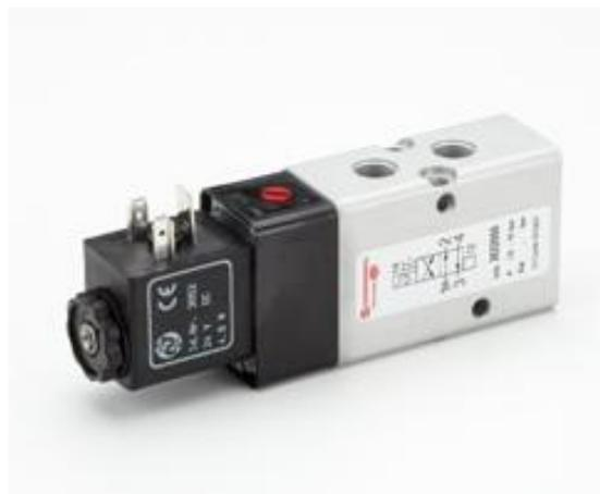
*Fig. 3.3.1 EL solenoide es un dispositivo electrónico que por medio de un campo magnético, es capaz de desplazar un vástago el cual, abre o cierra el paso de un fluido a través del cuerpo de válvula en el que es instalado.*
