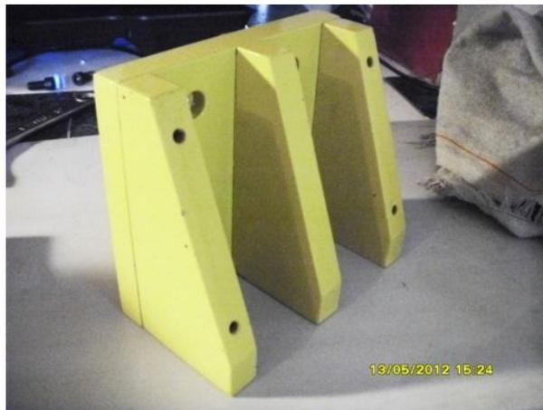
*Fig. 4.8.2 Los 4 barrenos visibles en los extremos del cabezal serán el punto de fijación de la placa de datos técnicos.*
