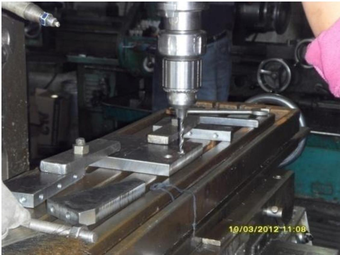
*Fig. 2.2.4.1 Es importante destacar que posterior al taladrado se realizaron distintos tipos de avellanados, cajas, tazas y roscados para la mayoría de los barrenos.*
