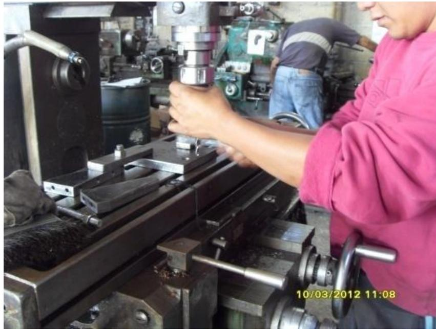
*Fig. 2.2.2.1 Con la finalidad de obtener superficies planas o de una forma concreta, las fresadoras son máquinas complejas en las que es la herramienta de corte es la que gira y la pieza es la que permanece fija a una bancada móvil. La herramienta utilizada es la fresa o cortador, que suele ser cilíndrica con diferentes filos cuya forma coincide con la que se quiere dar a la pieza a trabajar.*
