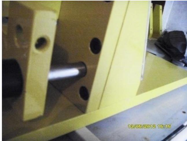
*Fig. 4.6.1 Las tazas o asientos destinados para la colocación de las guías, no requieren de tornillería para su sujeción.*
