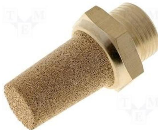
*Fig. 3.3.3 El silenciador es un dispositivo que suprime el estallido generado por la expansión de un gas cuando es liberado desde un recipiente a presión hacia la atmosfera.*
