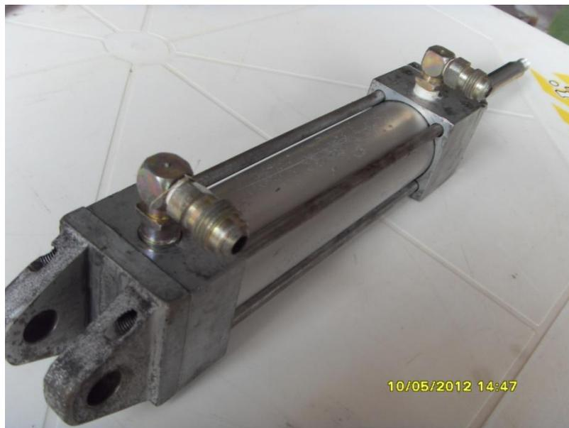
*Fig. 1.2.2 Actuador Hidroneumático de doble efecto.*
