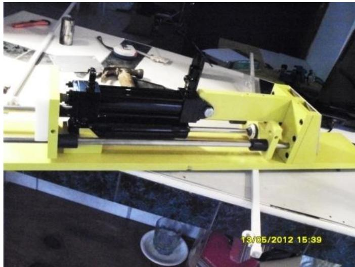
*Fig. 4.9.2 El soporte del actuador alojará de forma simultánea al conjunto de válvulas.*
