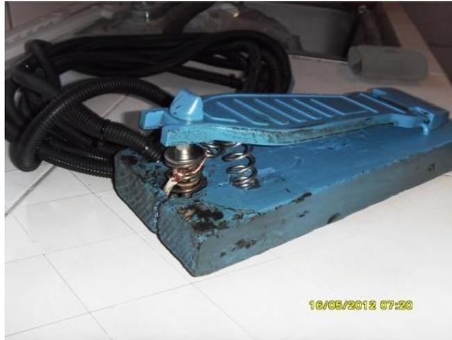
*Fig. 4.11.1 Pedal dispuesto sobre el interruptor. Un conjunto de resortes actúan simultáneamente para hacer retroceder el pedal cuando el operador deja de ejercer su peso corporal.*
