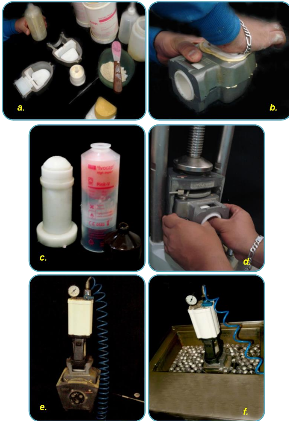
Figura 23. a. Material requerido y patrón de oclusión en yeso tipo II, b. Enmuflado de la dentadura, c. Cápsula nueva de inyección Ivocap® Ivoclar Vivadent®, d. Prensado de la mufla, e. Inyección de la resina acrílica a 6 bar de presión, f. Cocción en estufa Hanau. Fuente directa.
