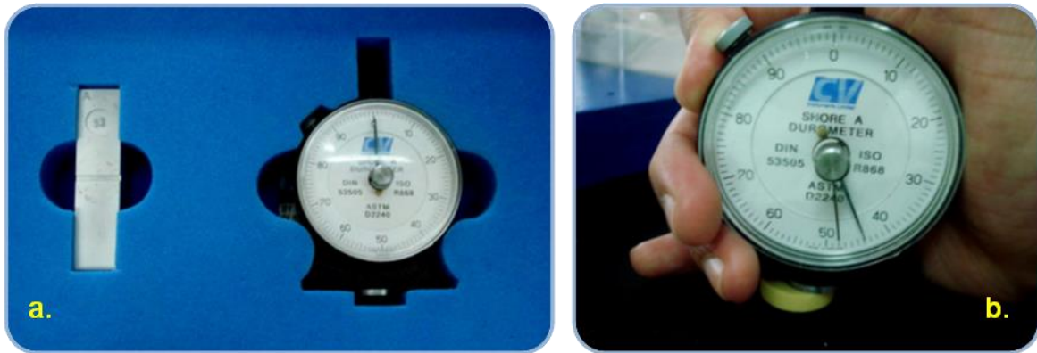
Figura 15. a. Durómetro modelo 306 L tipo A, b. Medición de la dureza en unidades Shore mediante la colocación del durómetro en cinco puntos diferentes de la tableta o alimento artificial. Fuente directa.
