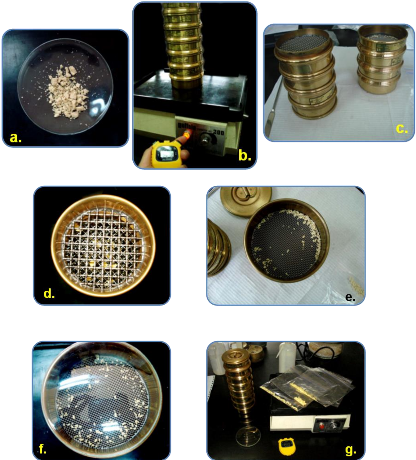
Figura 31. a. Tabletas masticadas después de su pesaje , b. Vibración durante dos minutos de las tabletas masticadas , c, d y e. Distribución de las partículas de la muestra en las diferentes aperturas de malla en la torre de tamices , f. Partículas listas para ser pesadas , y g. Almacenamiento de muestras después de su medición. Fuente directa.
