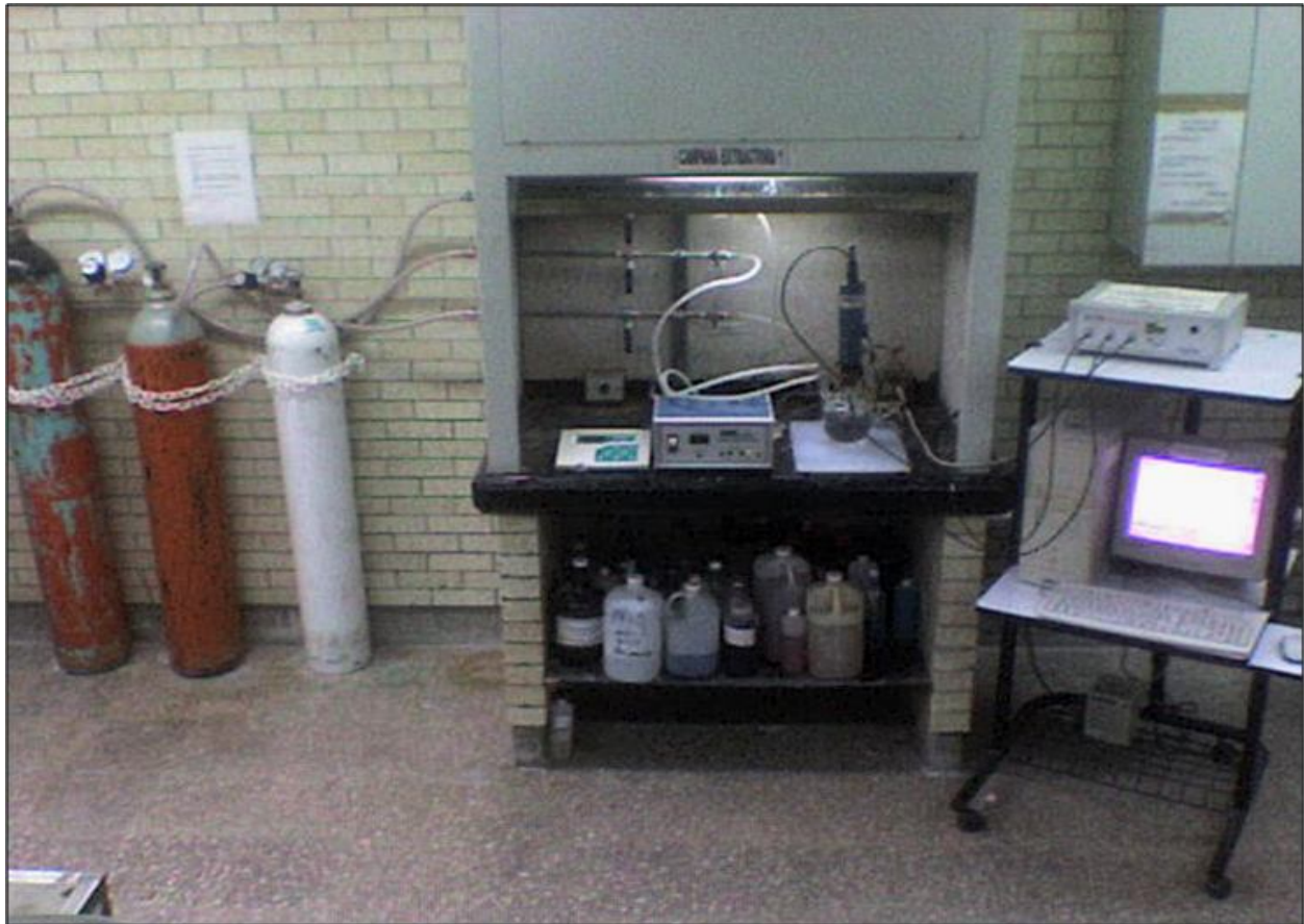
Figura 2.3 Foto del sistema instalado para el suministro de gases y celda electroquímica instalada con todos los dispositivos.
