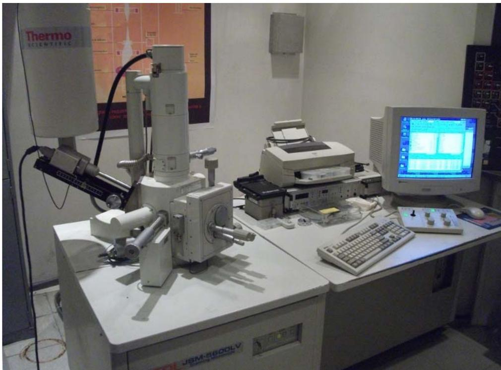
Figura 5.2 Microscopio electrónico de barrido Jeol 5600 LV.
