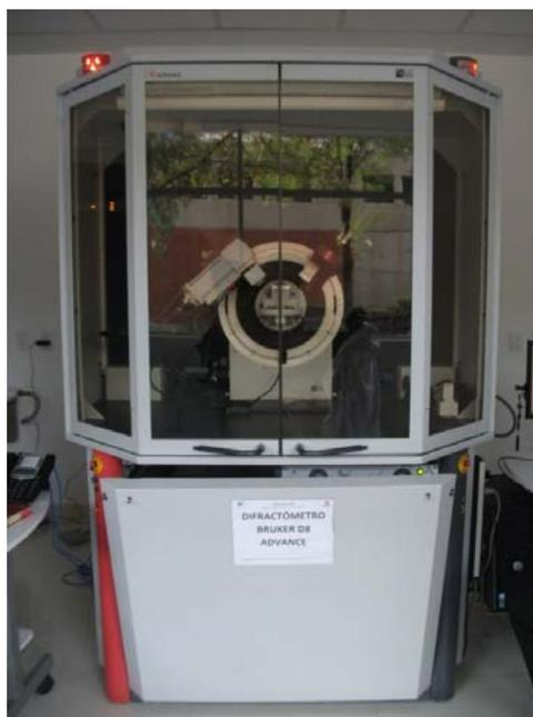
Figura 5.4 Difractómetro de rayos X Bruker Advanced D8.
