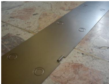
Figura 1.26 Ducto troquelado, listo para ser doblado.
