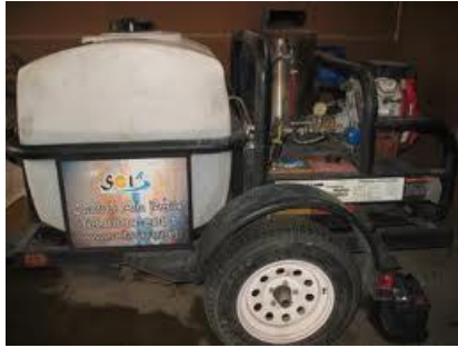
Figura 1.28 Hidrolavadora industrial utilizada para limpiar los ductos.
