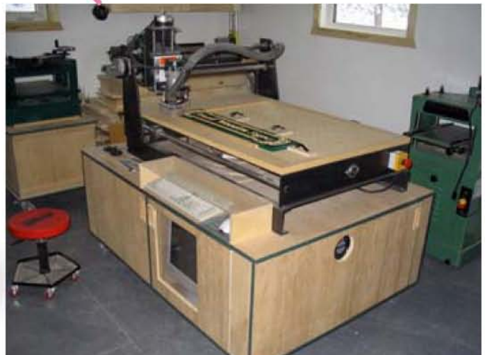
Router CNC (Computer Numerical Control) que trabaja como fresador y cortador de madera a partir de un sistema
