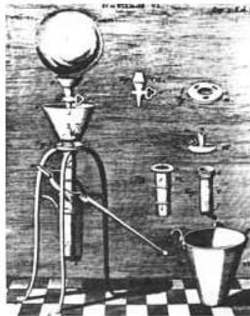
Figura 1.25. Bomba de aire de Von Guericke usada en la demostración en Berlín y Magdeburgo. (Farías, 1995)
