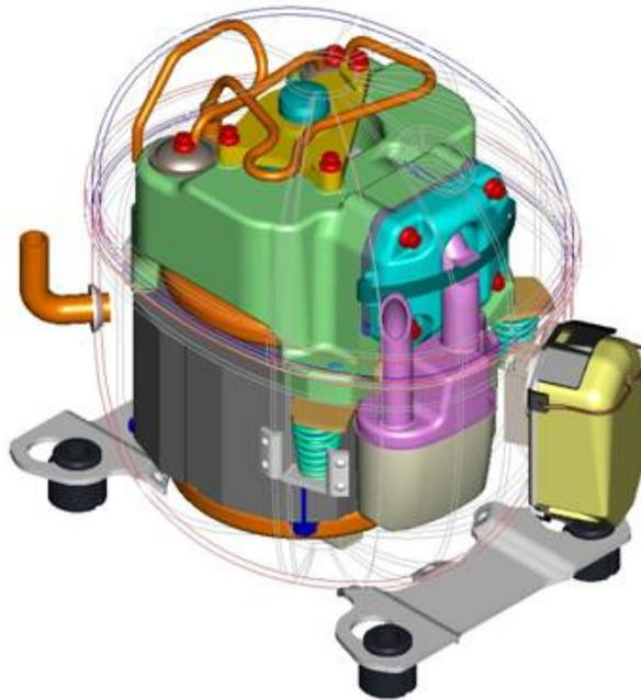
*Figura 38 Compresor recíprocante tipo hermético.*
