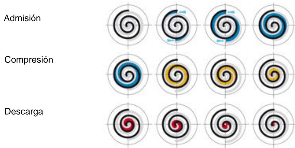
*Figura 35 Fases de trabajo del compresor scroll.*
