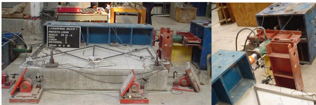
Figura 3.28 Aplicación de carga lateral pruebas a Cortante
