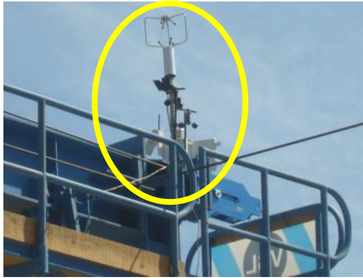
Figura 5.3 Fotografía de un anemómetro ultrasónico durante la construcción del puente Baluarte, carretera Durango – Mazatlán.
