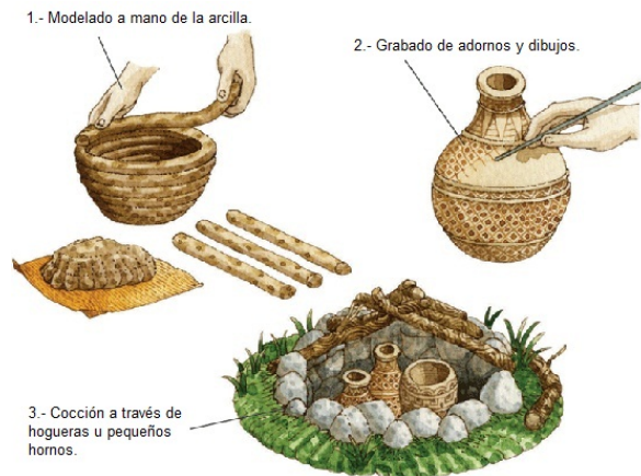
Figura 2.2 Proceso para la elaboración de piezas cerámicas tradicionales.
