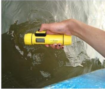
Fig. 9. Ecosonda Depthmate, SM-5
