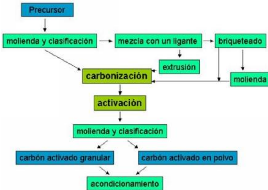
Figura 4. Diagrama de la activación física del carbón activado.
