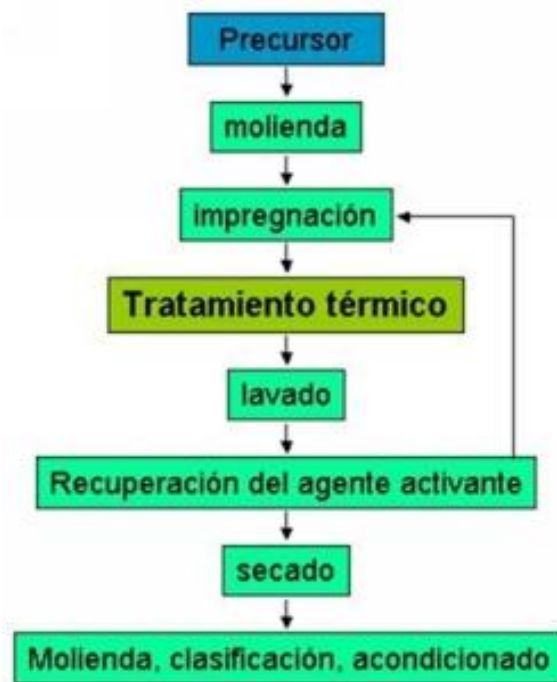
Figura 5. Diagrama de la activación química del carbón activado.
