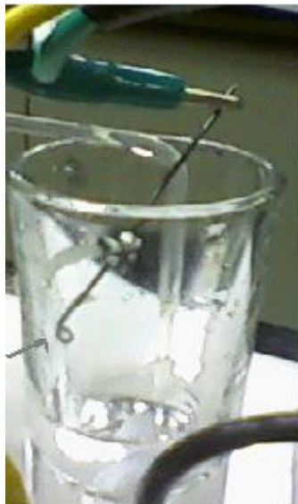
Figura 10. Hilo de plata como electrodo indicador
